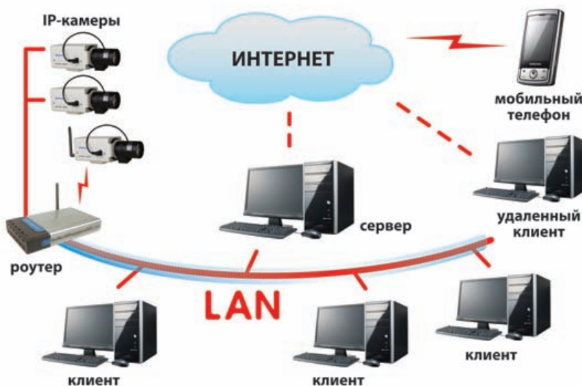
Рис. 1. Архитектура сети видеонаблюдения на основе IP-оборудования
