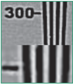
Рис. 6. Фрагмент изображения тест-таблицы для IP-камеры
