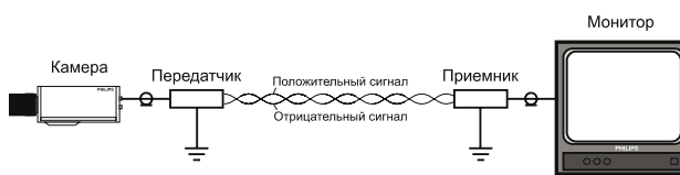
Рис. 5. Схема передачи ТВ сигнала по витой паре
