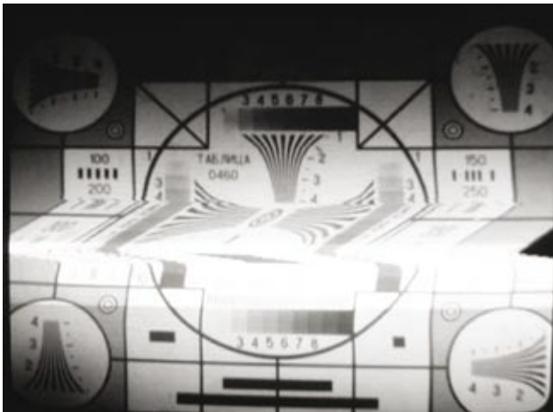
Рис. 1. Фоновая наводка, вызванная паразитными земляными токами
