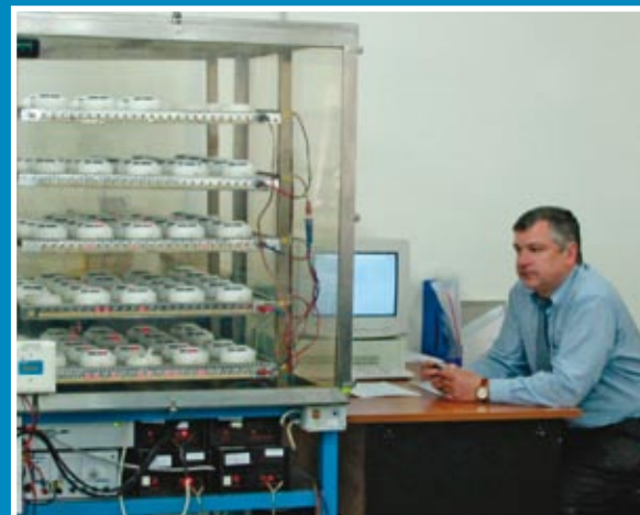
Burn-In тест: проходят 100% дымовых извещателей
