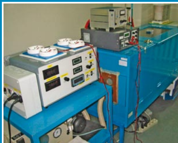
Измерение чувствительности дымовых извещателей
