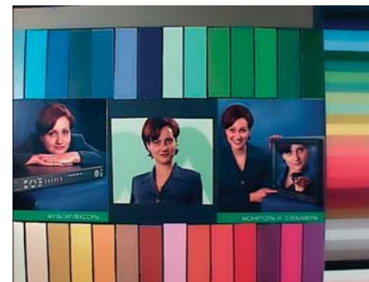
Изображения, формируемые камерой "день/ночь" VMC-745. В режиме "ночь" (слева), освещенность на тест-таблице 0,0008 люкс (F0,75), отношение сигнал/шум 10 (20 дБ). В режиме "день" (справа) освещенность 1000 люкс.
